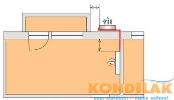
Схема 7 монтажа кондиционера сплит-системы
