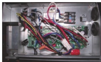
Плата управления внутреннего блока
